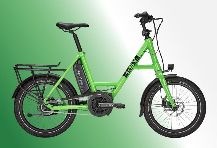
Pedelec = Fahrrad mit elektrischer Antriebsunterstützung.
