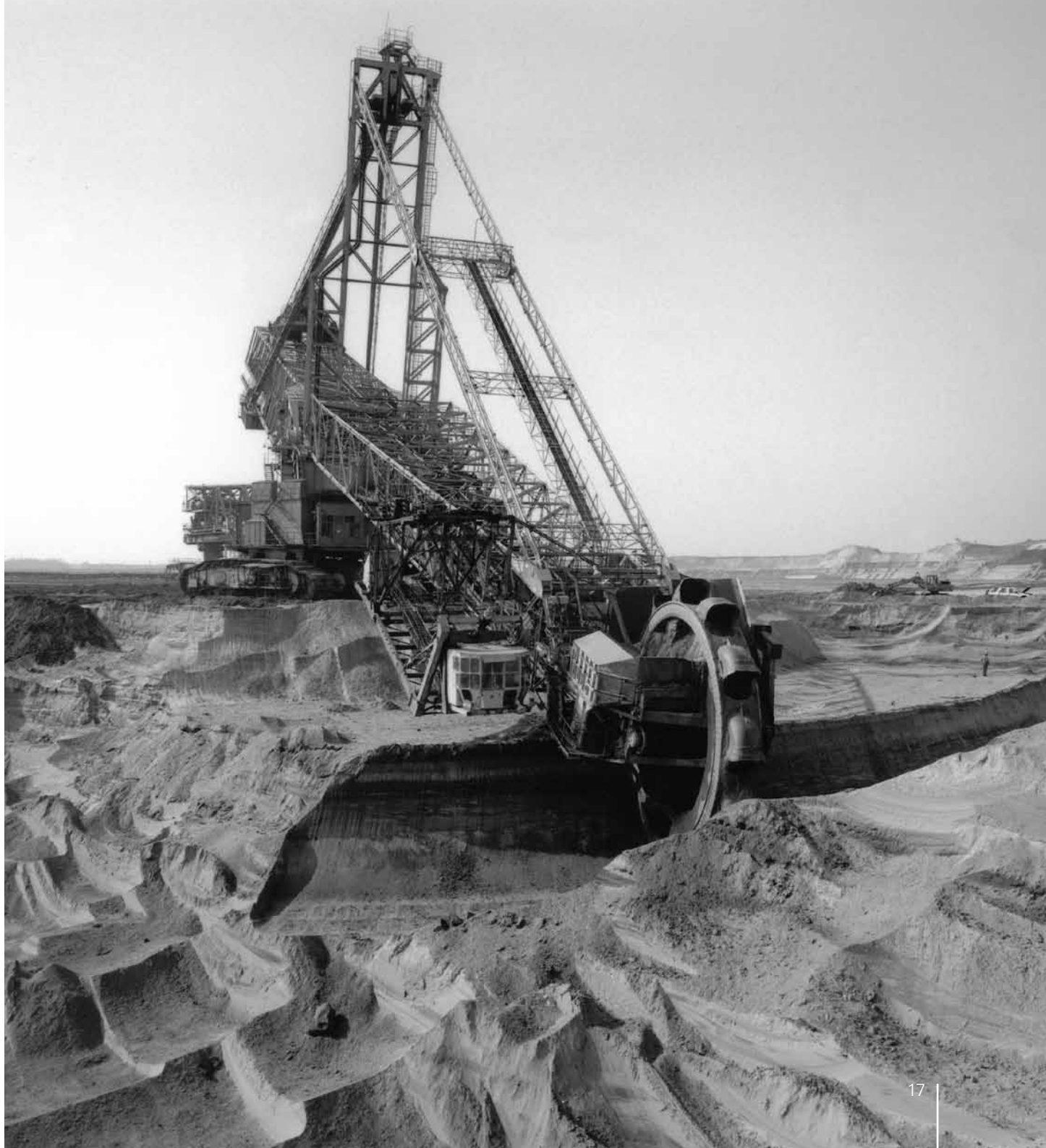
Schaufelradbagger SRs 1500 -1473 mit umgedrehtem Schaufelrad im Tiefschnitt bei der Suche nach Altbergbaustrecken, 1995
