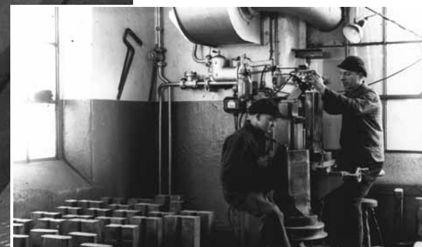
Formleger bei der Herstellung von Stempeln für Briketts in der Brikettfabrik Marga in Brieske, um 1925
